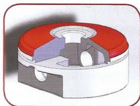
**Geometria especial dos pistons Bertolini:** A forma dos pistons Bertolini foi estudada de modo que a parte superior não está em contacto directo com as membranas. Entre o pistão e a membrana, há sempre uma camada de separação de óleo, isto evita o desgaste das membranas.
